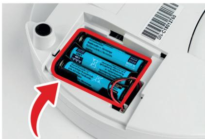
5. Inserire prima il contenitore delle batterie alcaline e successivamente sistemare con delicatezza il cavo nell'incavo in basso
